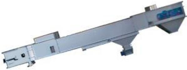
Цепные или скребковые конвейеры предназначены для транспортировки сухих материалов, таких как порошки, гранулы, зерно. Продукт транспортируется по дну корпуса с помощью прямоугольных скребков, которые крепятся под направляющей цепью. Направляющая для цепи сделана из стали Polyzene® или из марганцовистой стали в зависимости от применения.
